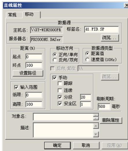
c. 单击数据源右边的 **浏览...** 按钮，打开标签浏览对话框，选择所需的标签名，按标签浏览对话框中的**确定**按钮，标签名分别显示在主机名，服务器名，标签名右边的编辑框中。
