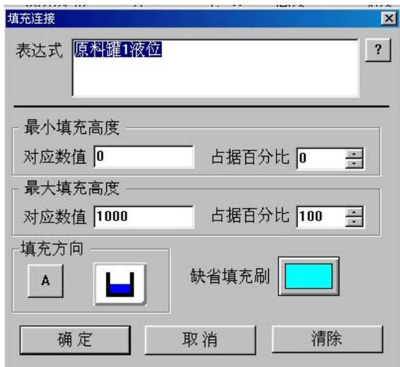
作为一个实际上可用的监控程序，可能操作者仍需要知道液面的准确高度，而不仅仅是设置刻度。这个功能由“模拟值输出”动画来实现。在工具箱中选用文本工具，在“1号原料罐”矩形框的中部输入字
