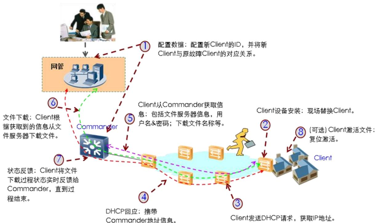
故障设备替换的流程如图 2-31 所示，以下逐个说明。
