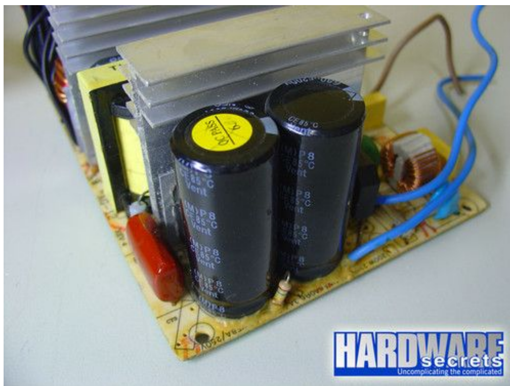
两颗巨大的电解电容组成的倍压器
