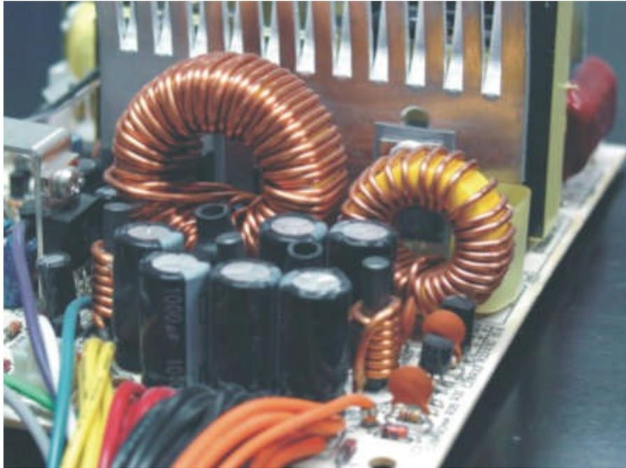
直流线路 EMI 滤波器比较复杂。电源的直流有 5V、12V 和 3.3V 电压，对于每路电压，都需要进行滤波。低压端通常有两个大的扼流线圈，其中稍大的对 +5V 和 +12V 进行滤波，稍小的对 +3.3V 进行滤波。另外，磐石 355 的低压大容量滤波电容和线圈型电感数目也较多，共有 6 个，5V、12V 和 3.3V 各使用 2 个滤波电容和 1 个线圈电感。这样设计可以取得非常好的滤波效果。如下图所示。
