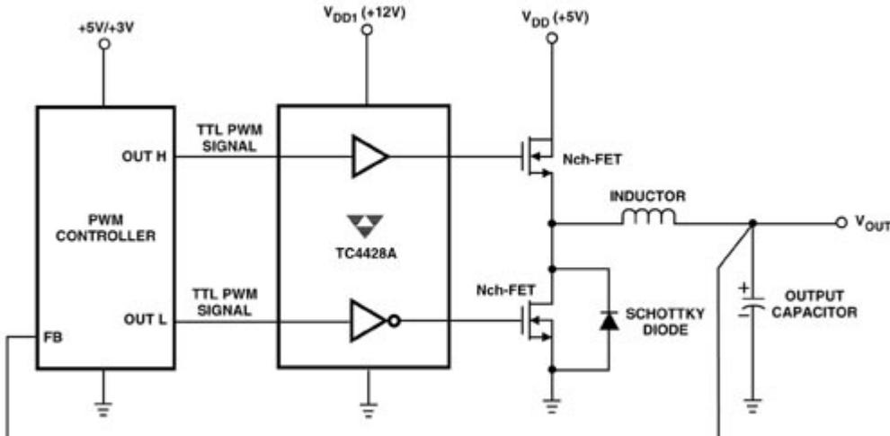
功率MOSFET以其导通电阻低和负载电流大的突出优点，已经成为SMPS控制器中开关组件的最佳选择，专用MOSFET驱动器的出现又为优化SMPS控制器带来了契机。那些与SMPS控制器集成在一起的驱动器只适用于电路简单、输出电流小的产品；而那些用分立的有源或无源器件搭成的驱动电路既不能满足对高性能的要求，也无法获得专用单片式驱动器件的成本优势。专用驱动器的脉冲上升延时、下降延时和传播延迟都很短暂，电路种类也非常齐全，可以满足各类产品的设计需要。
