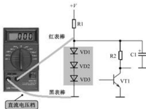
图 1.2 测量二极管上直流电压接线示意图
