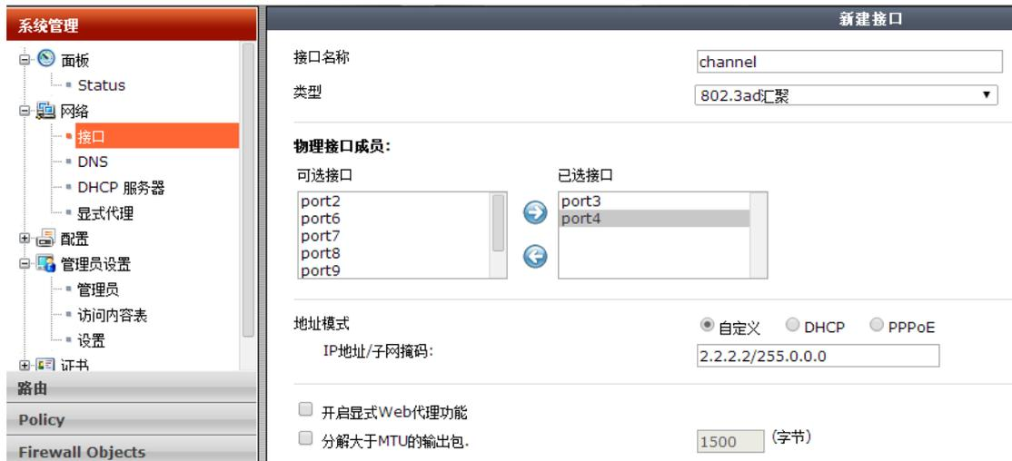
FortiGate 链路聚合需要两个或者两个以上,最大支持到八个接口,配置链路聚合的接口必须具备以下条件:
