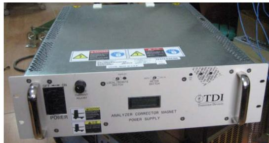
图2——一台TDI的10.5kW输出直流开关电源
